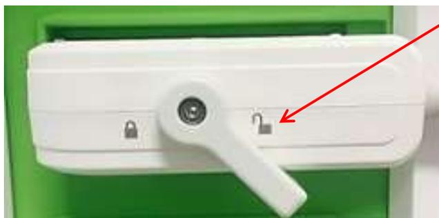
Manopola di bloccaggio sul connettore del trasduttore (in posizione di sblocco)
